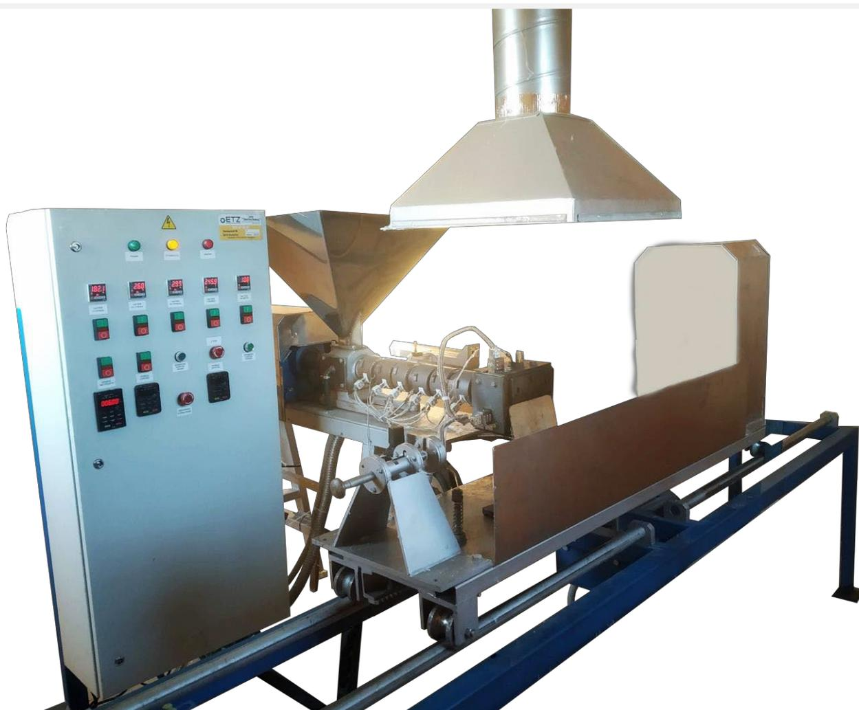
Линия по производству волокнисто-пористых материалов предназначена для изготовления фильтров из фильтропласта, гидрофобных сорбирующих материалов, трубчатых и плоских аэрирующих элементов.
