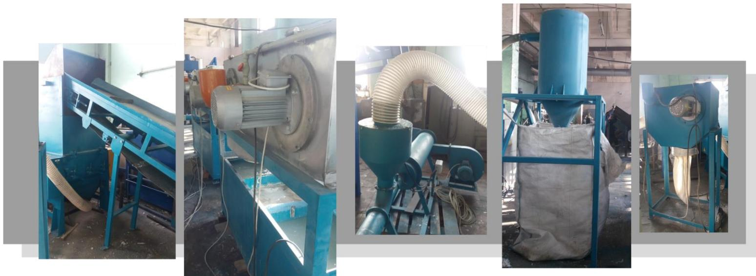
Линия по сортировке, измельчению, сухой очистке, мойке, сушке загрязненной полиэтиленовой пленки, полипропиленовых мешков, отсортированных вторичных «мягких» и «твёрдых» полимеров. Производитель оборудования гарантирует очистку полимеров от песка, пыли, органики, других видов и типов загрязнений, частиц металла, стекла, для последующей переработки в агломерат, гранулы, готовую продукцию по ТУ 2298-014-05766623-99.
