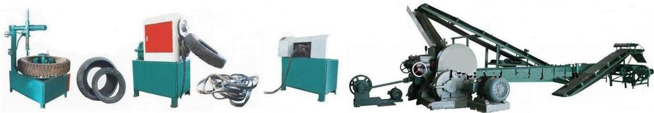
Полуавтоматические линии измельчения шин ЛПШ производительностью от 50 до 600 кг/ч в зависимости от комплектации. Линии ЛПШ включают в себя оборудование для поэтапной разделки и измельчения шин, сепарации частиц проволочного и текстильного корда, разделения частиц резины на фракции. Линии представляет собой экономичное решение, просты в эксплуатации и обслуживании.
