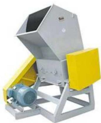
■ Дробилки оснащены ножами из высококачественной, износостойкой стали с твердостью после закалки HRC 52-58.
