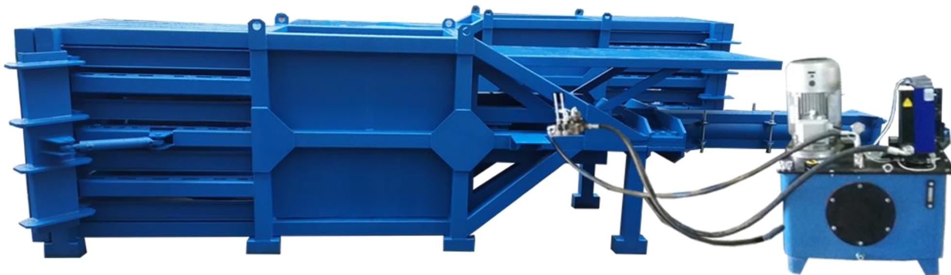
Пресс предназначен для пакетирования макулатуры, картонных коробок и прочих бумажных обрезков, отходов пластика и пленки, алюминиевых и жестяных банок, металлических стружек цветного и черного металлов, также других отходов производств, ветоши и прочего объемного мусора.
