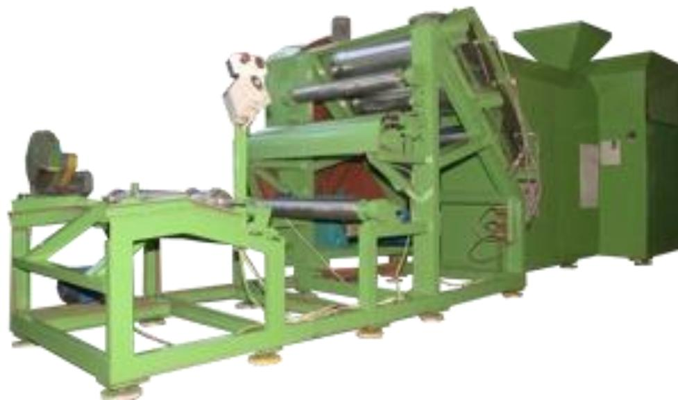
Линия по производству полимерно-резиновых изделий (далее по тексту ЛПРИ) предназначена для изготовления полимерно-резиновых изделий (кровельных материалов различной конфигурации и форм, фасадной, ветровой, карнизной, коньковой черепицы, доборных элементов, гидроизолирующих материалов с перспективой дальнейшего производства полимерно-резиновых покрытий для детских и спортивных площадок).
