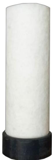
Состоят из хаотически расположенных волокон термопластичного полимера – полиэтилена низкой плотности, сплавленных между собой в местах контактов. Технология производства основана на модернизированном аэродинамическом способе и позволяет получать как трубчатые элементы любого диаметра и длиной до 2-х метров, так и плоские элементы. Пористость их может быть постоянной или переменной по толщине в заданных пределах.
