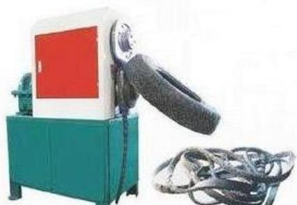
Станок, работающий по принципу дисковых механических ножниц, разрезает покрышку на ленту шириной от 30 до 70 мм (в зависимости от настроек) до второй боковины.
