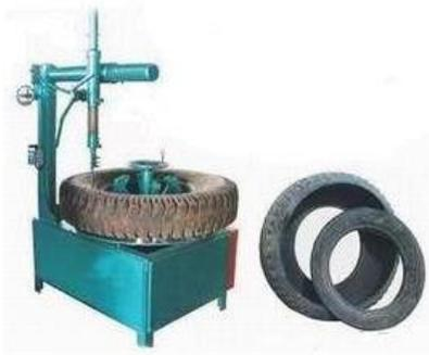
Станок для вырезания боковин производит первичную разделку шины, вырезая одну боковину.
